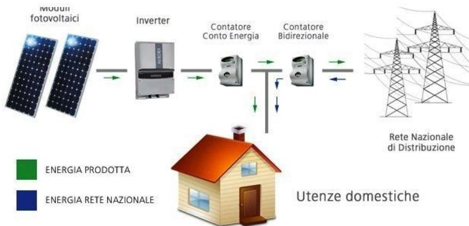
Il fabbricato sarà dotato di impianto fotovoltaico autonomo per ogni singola unità abitativa per una potenza nominale di Kw 2 ad appartamento.
