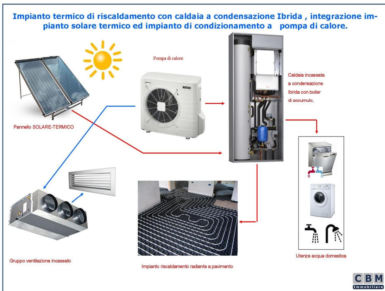
L' impianto di riscaldamento sarà del tipo autonomo, idoneo a garantire le temperature di legge, con distribuzione radiante a pavimento per il solo riscaldamento e distribuzione ad aria con ventilconvettore canalizzabile ubicato nel disimpegno per il condizionamento. Il sistema termico riscaldamento/condizionamento sarà di tipo Ibrido, ovvero la produzione di acqua calda per
