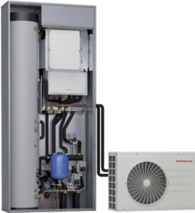
riscaldamento e sanitaria saranno prodotte sia da caldaia a gas di tipo a condensazione, che da pompa di calore con alimentazione elettrica. Il sistema utilizzato sarà determinato automaticamente dall'impianto in base alla maggior convenienza nel momento di utilizzo in base alla temperatura interna richiesta, quella esterna ed in base al costo del gas metano e dell'energia elettrica impostate dal tecnico o dall'utente stesso.
